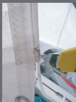
3. タック部でボルトロープがとめられている糸を取り除いて、ラフテープにテンションをかけながら、ボルトロープをラフテープの中に入れていくます。タックのコーナーがロアーバンド上約3-4cmにくるところでラフテープのエン部にあたるボルトロープにマーキングをしておきます。
