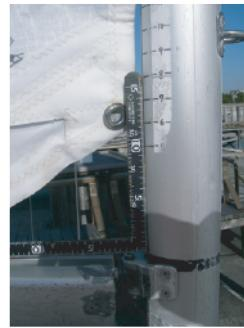
(A) ボルトロープのテンションが適正でタックの高さが適正な場合
