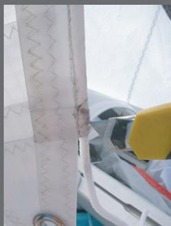
3. タック部でボルトロープがとめられている糸を取り除いて、ラフテープにテンションをかけながら、ボルトロープをラフテープの中に入れていきます。タックのコーナーがロアーバンド上約2-3cmにくるところでラフテープのエンド部にあたるボルトロープにマーキングをしておきます。
