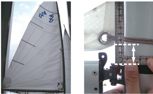
(A) ボルトロープのテンションが適正でタックの高さが適正な場合
