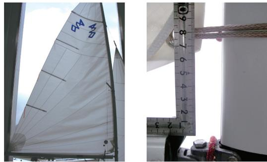
(B) ボルトロープがシュリンクしてタックが高く破損の恐れがある場合
